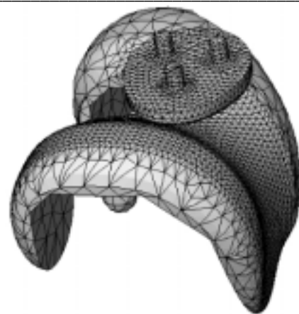
圖九 利用有限元分析軟體 cosmos 所產生之網格：(a)Advantim 及(b)Duracon 之網格圖
