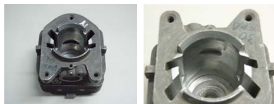
圖 2 經機械加工後、未電鍍前之 30 C.C.汽缸體
