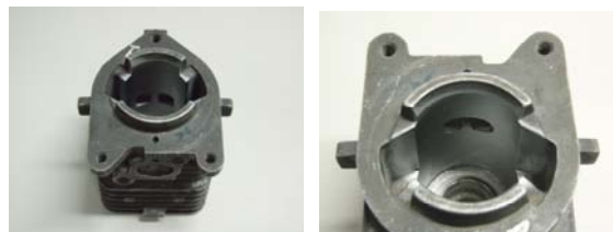
圖 1 經電鍍後、未拋光處理前之 25 C.C.汽缸體
