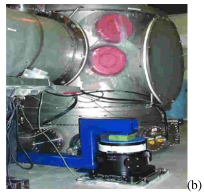
圖 1 懸吊式減振平台(a)示意圖(b)實物照片
