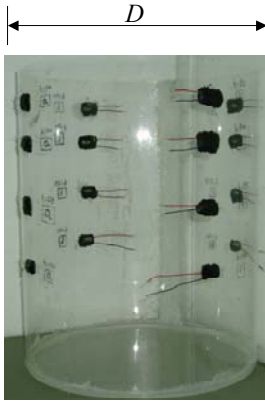
圖五 壓克力儲槽之模型
